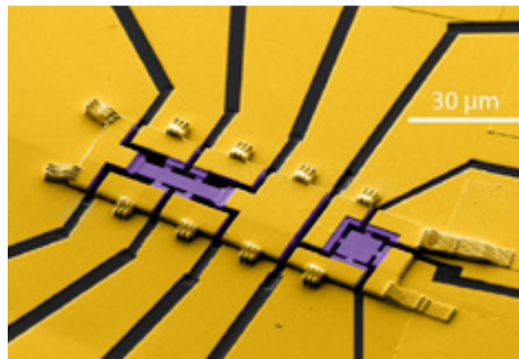
Figure 3. Microstructure d'un matériau quantique WP2 (EPFL, Philip Moll).
